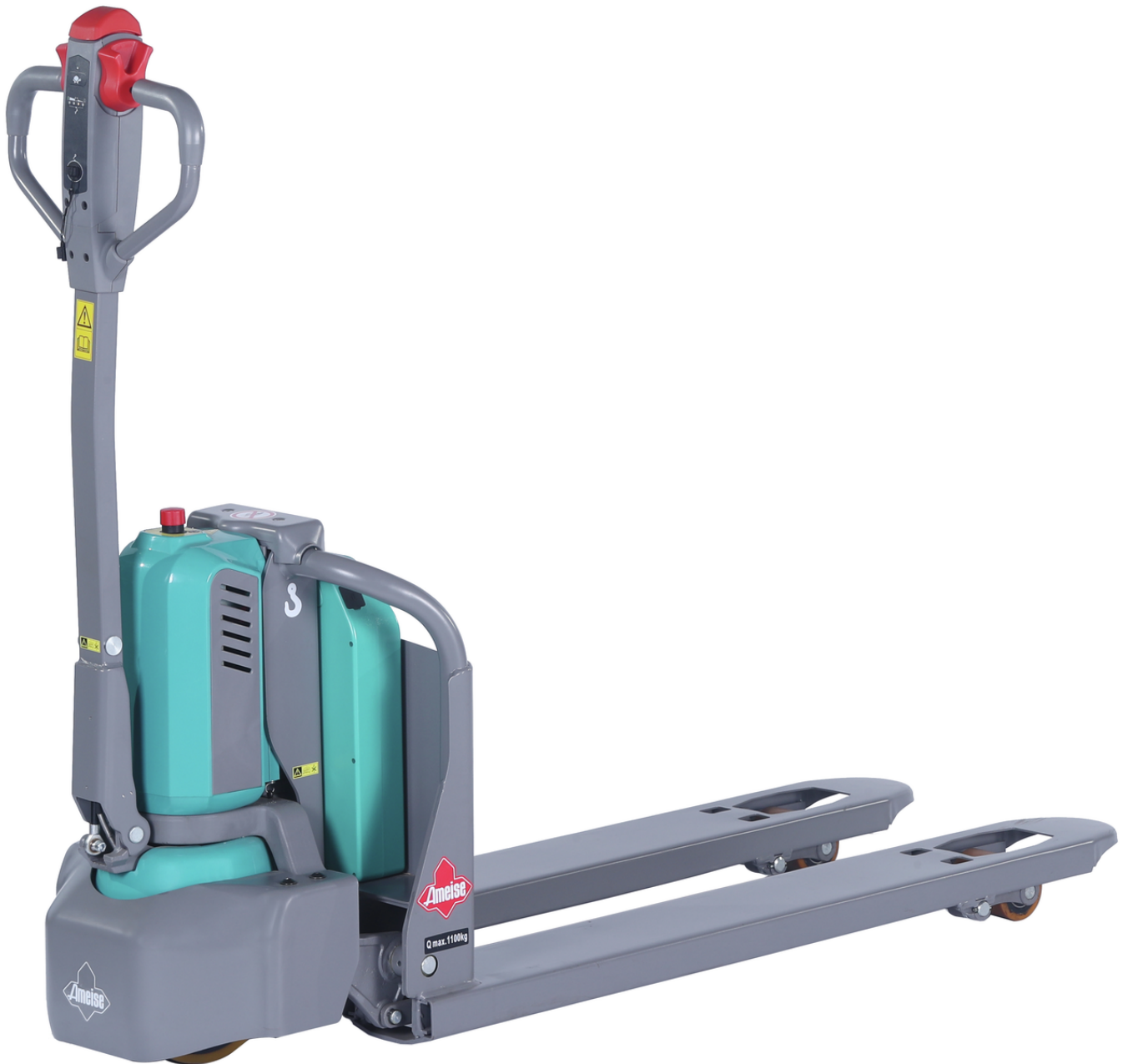
Ameise PTE 1.1 Elektrisk låglyftare/ledtruck (1100 kg)
